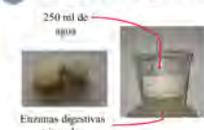
Para cada bioplástico se utilizaron dos recipientes. Uno de control contenido de retazos de bioplástico, previamente, pesado y registrado, fotográficamente con 250 ml de agua, y otro experimental que tenía además, dos cápsulas de enzimas digestivas. Después de 24 horas se volvió a pesar y se registró, fotográficamente.
