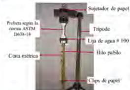
Se colocó sujeta papeles en los extremos de la probeta. En el extremo suspendido se amarró un hilo pabilo donde se colocaron pesos de siete gramos cada uno (utilizando clips de papel). Estos pesos fueron colocados, progresivamente, hasta llegar a la fractura mientras se registraba la elongación con respecto al peso que soportaba para así obtener datos para la gráfica de esfuerzos-deformación.
