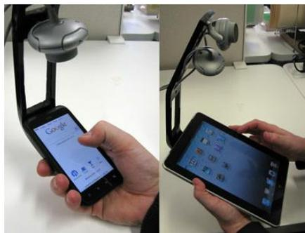
**Figura No. 2.16 Dispositivo Claw-Hand anclado tanto a un Smartphone (izquierda de la imagen) como a una Tablet (derecha de la imagen).**
