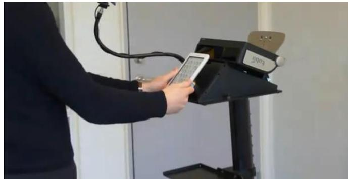
**Figura No. 2.28 Sensor Acoplable en el Carrito Eyetracker Marca Tobii**
