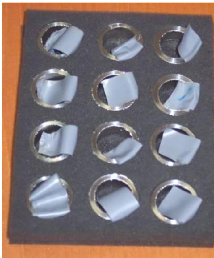
*Figura 2.35 Probetas para la medición de tensiones residuales.*
