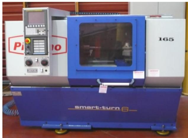
*Figura 2.1 Torno de control numérico Pinacho CNC mod. Smart-turn 6/165.*
