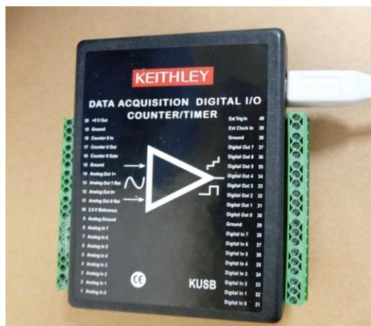
Figura 2.17 Tarjeta de adquisición de datos.
