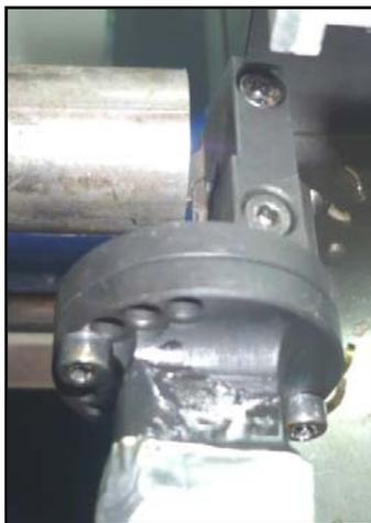
*Figura 2.13 Portaplaquitas y tubo mecanizado.*
