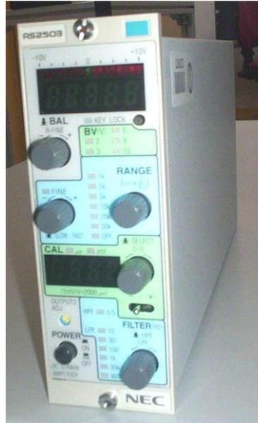
Figura 2.16 Amplificador/filtro de señal.
