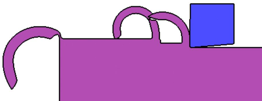
*Figura 1.3 Modelo numérico de pasadas sucesivas.*
